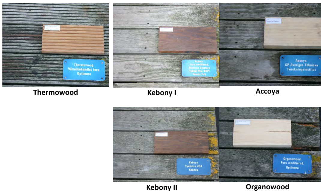
Figur 12. Utseende hos det modifierade träet vid inspektionen 2019.
